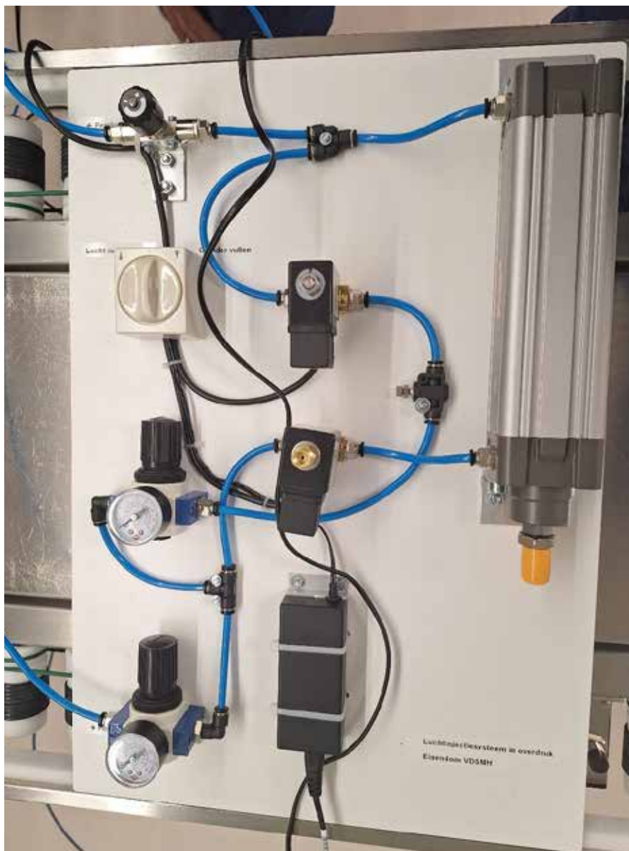
Figuur 1 VDSMH luchtinjectiesysteem
