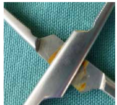
Naaldvoerder met problemen in het boxlock scharnier
