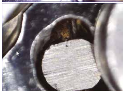
Nog vuil op de bekjes wat niet met het blote oog, of zelfs met de loop te zien is.
