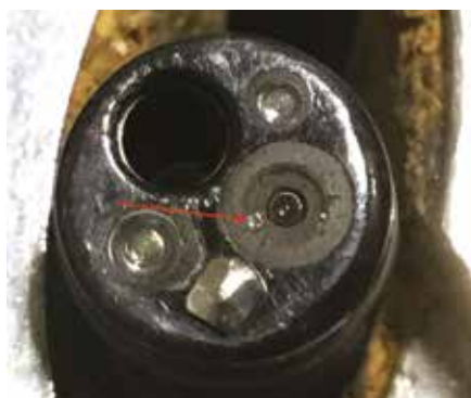
Zo zou de tip van een leen endoscoop eruit kunnen zien.
