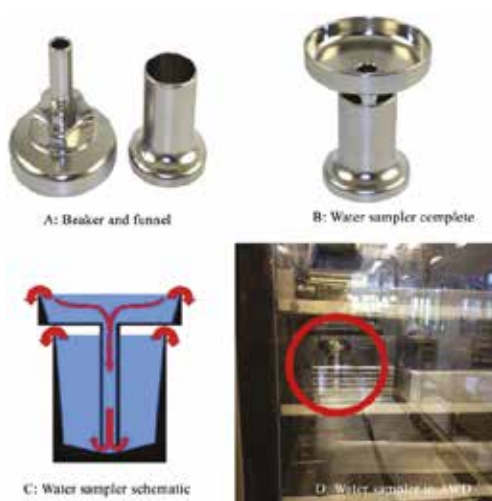
Afbeelding 1. Watermonsternemer (WMN) (A) Onderdelen van de watermonsternemer (WMN): een trechter en een bekeerglas. De trechter is zo breed dat water alleen via de trechter in het bekeerglas terecht kan komen. (B) WMN zoals gebruikt in een desinfecterende wasmachines. De roestvrijstalen WMN is dusdanig geconstrueerd dat deze niet omvalt tijdens een proces, bijv. door de kracht van een waterstraal. (C) Het principe van de WMN: de rode pijlen geven de stroomrichting van het water aan. Tijdens een cyclus wordt water opgevangen door de trechter. Dit stroomt vervolgens in het bekeerglas. De uitloop van de trechter reikt bijna tot de bodem van het bekeerglas. De bodem van het bekeerglas is zo geconstrueerd dat het opgevangen spoelwater omhoog het bekeerglas uit wordt gestuwd. Hierdoor bevat de WMN aan het eind van het proces hoofdzakelijk het laatste spoelwater. (D) De plaats van de WMN in alle desinfecterende wasmachinestests in dit onderzoek.
