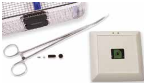
Net en instrument met RFID Tag en reader voor automatische scan
