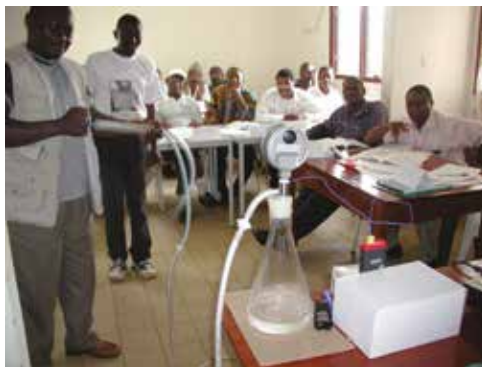
07-04-2008. Kumba, Kameroen. Proef om het drogen in een autoclaaf te verklaren met behulp van een vacuüm.
