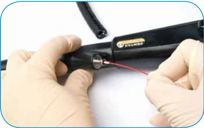
Invoeren: Kabel eerst.
