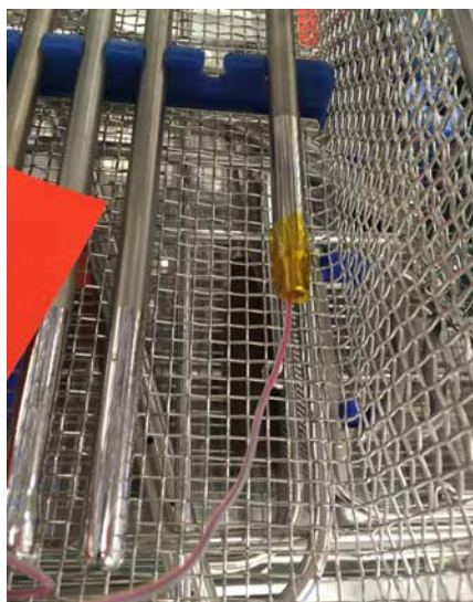
Draadloze logger met flexibele voeler, kan ook in holle instrumenten worden geplaatst.
