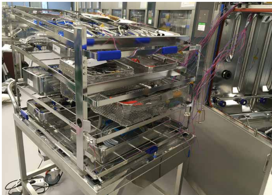
Opstelling validatie met thermokoppels, geen enkele set kan verder worden verwerkt, de washer wordt ontladen aan de inlaad (vuile) zijde.
