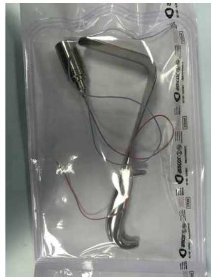
Draadloze logger, volledig in een laminaatzak (zonder gaatje in de laminaatzak).
